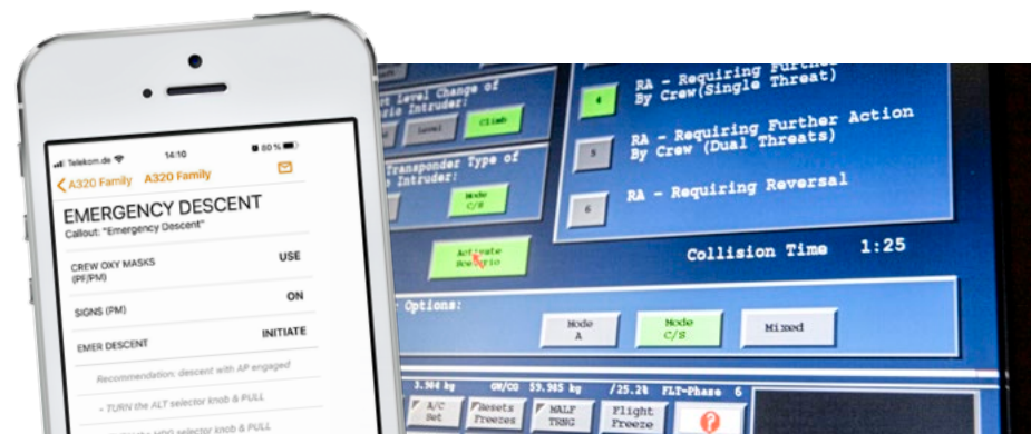
Blick auf das Steuerpanel des Simulators, mit dem der Operator jedes Notfallszenario auf die Leinwand bringen kann. Links das Memory Item für den Emergency Descent im Airbus A320.
